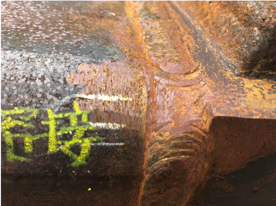
状況写真② 自動溶接(ロボット溶接)と比較すると ND コア側の溶け落ちはない。
