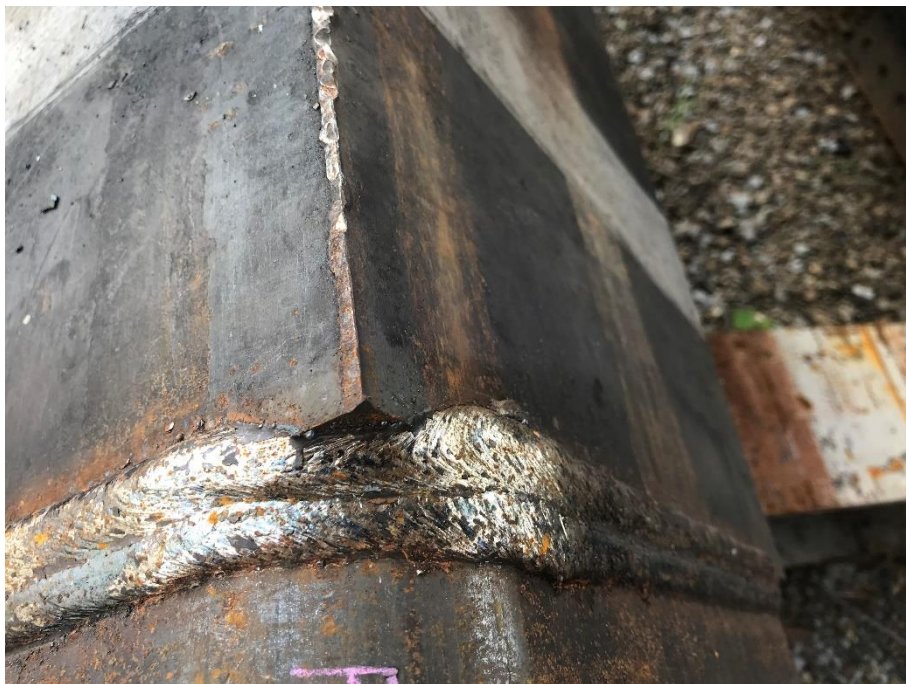
状況写真② ND コアの母材が溶け落ちているが板厚 12mm と比較し R 部の曲率が緩やかな為、溶け落ちの度合いは少ない。
