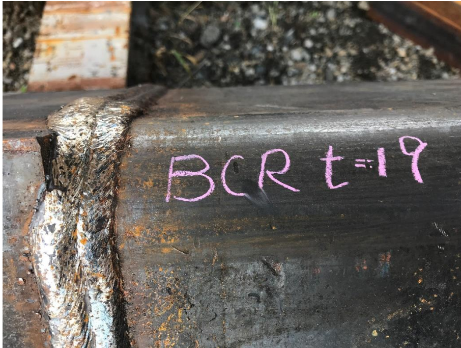
状況写真② ND コアの母材が溶け落ちているが板厚 12mm と比較し R 部の曲率が緩やかな為、溶け落ちの度合いは少ない。
