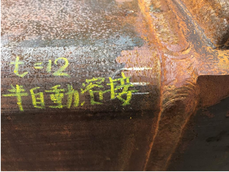
状況写真② 自動溶接(ロボット溶接)と比較すると ND コア側の溶け落ちはない。
