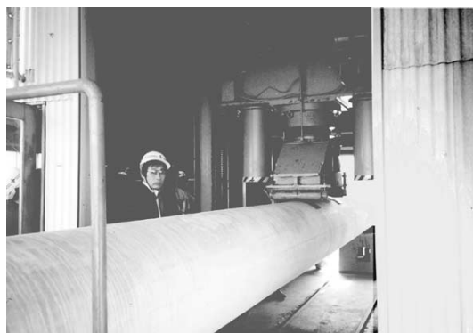
杭の曲げ試験
