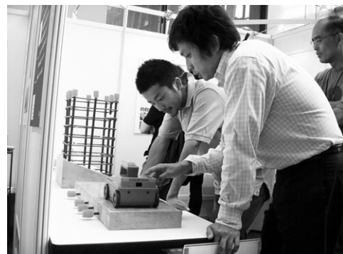
電磁波レーダーによる鉄筋探査
