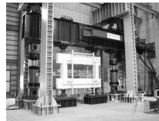
図-3 フレーム補強試験体動的実験
