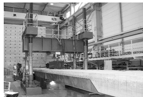
ST床版実大載荷試験
