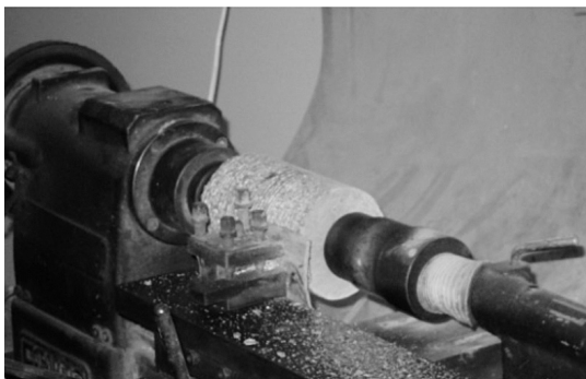
冷凍された砂質試料を削り出し
