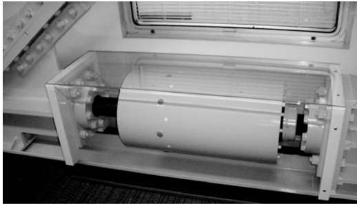
写真1 慣性こま(質量効果1350ton、錘外径400φ)
